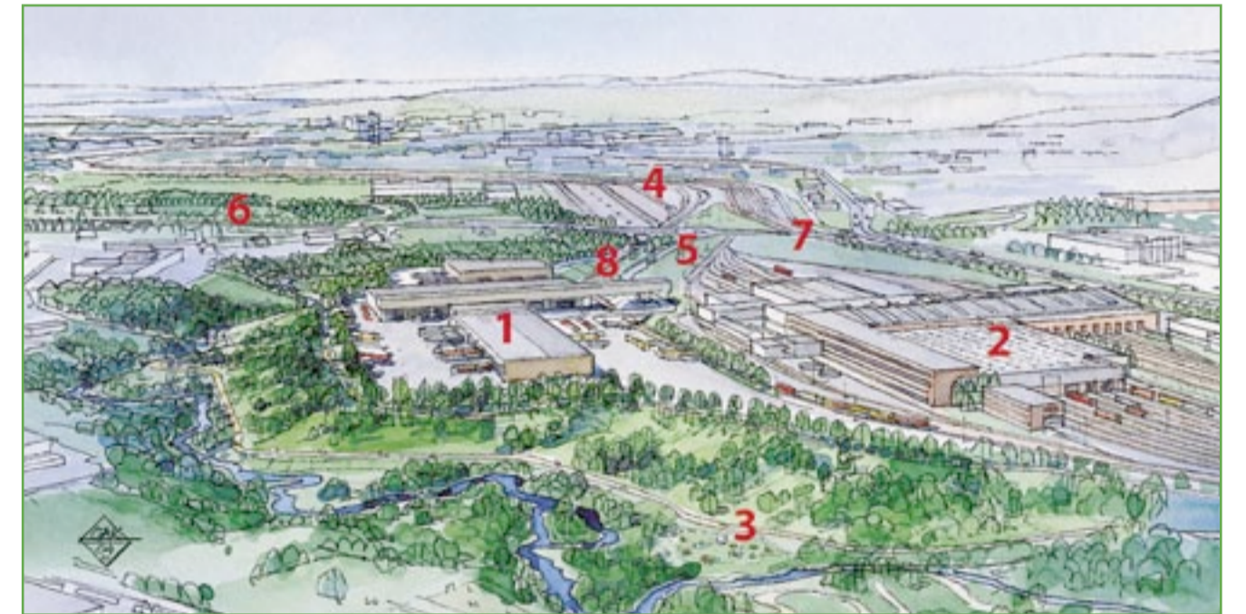
Sett ovenfra: Nyland Syd-terminalen (1), Alnaparken utvides (3), vedlikehold for bane og anlegg på Grorud Verksted (2), på Alnabru lastes gods fra og til bil og jernbane (4), Nedre Kalbakkvei får ny tilkjøring til terminalene (5), intern transportvei mellom terminalene og verkstedet (7). Bak: Alfaset gravlund (6). (Tegning: Ole Krogness, IN/BY)
